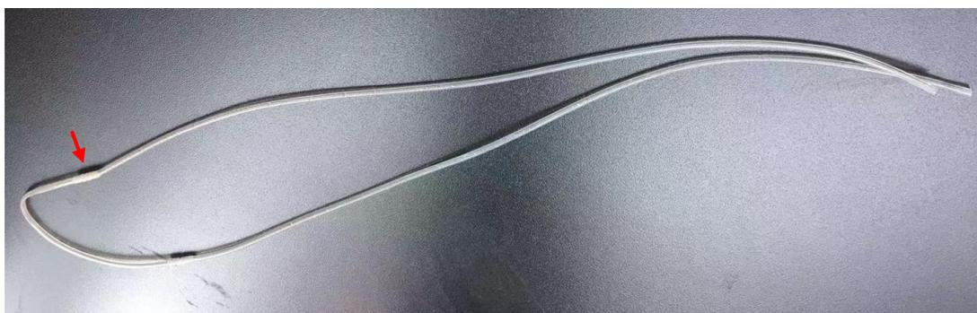
两长+一短塑料管 用白色连接头接好后放入烧杯灭菌
