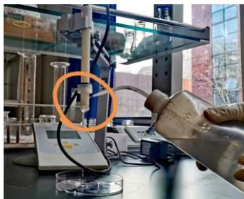
1 用水冲洗净探头上的 KCL，冲洗液用废弃培养皿接着就好
