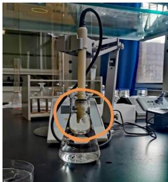
2 将探头浸泡在水中（注意不要磕碰到探头里的那个最值钱的小玻璃珠）（注意浸没的分寸），示数稳定后以此作为基准
